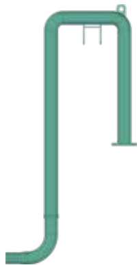
4"配水管③(送り)
